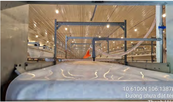
NEMA1 - アヒル農場用の自動糞収集システムアプリケーション
